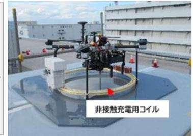
(参考) ドローン用非接触電力伝送装置
