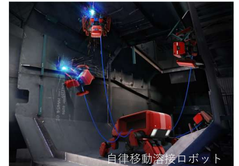
自律移動溶接ロボット
