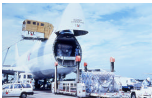
貨物専用機の積卸し作業
