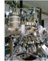
結晶成長装置 (InGaN薄膜形成に成功等)
