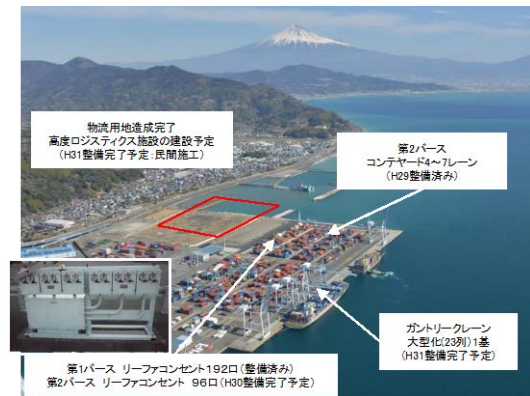
清水港新興津地区国際海上 コンテナターミナルの整備 (静岡市)
