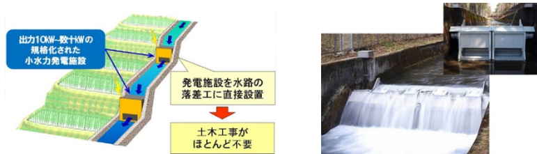
低落差型小水力発電機の採用
