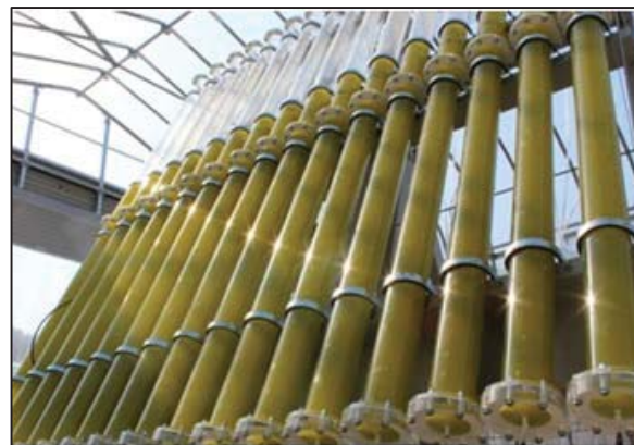
藻類バイオマス原油を生産する藻類の培養装置（茨城県つくば市）
