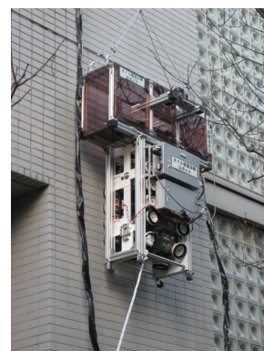
実証実験の状況 (外壁診断ロボット)
