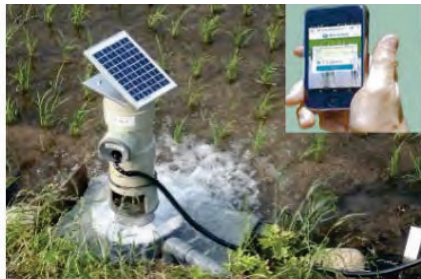
水管理の省力化のための 自動給水栓の設置
