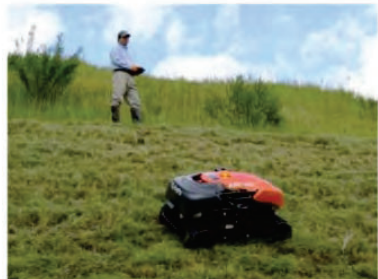
リモコン草刈り機の導入のための 法面の緩傾斜化
