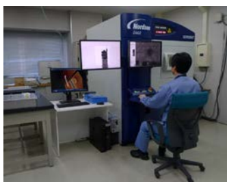
長野県工業技術総合センター 高解像マイクロフォーカスX線検査装置
