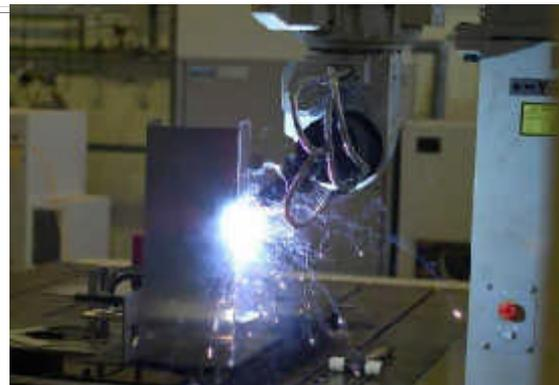
レーザ溶接による最先端アルミ加工技術の開発
