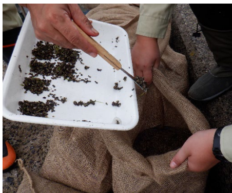
麻袋に腐葉土混合砂、種子、砕石を投入し、モニタリング
