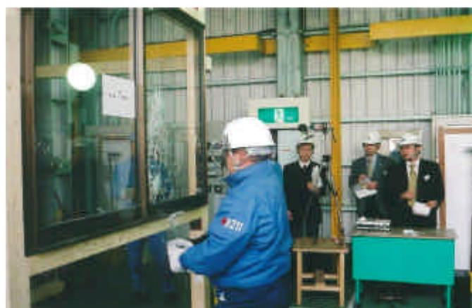
〔玄関用ドア、錠、窓、シャッター等の建物部品について、防犯性能試験を実施し、5分間以上侵入を防ぐ性能を有するものを防犯性能の高い製品として目録に掲載、公表〕
