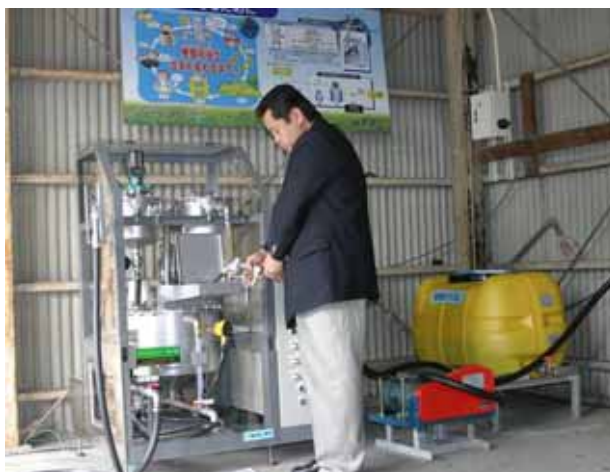
廃食油を軽油代替燃料とする装置 廃棄物の再利用と石油代替エネルギーの製造
