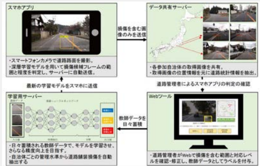
IoT・機械学習を用いた道路舗装損傷の自動抽出
