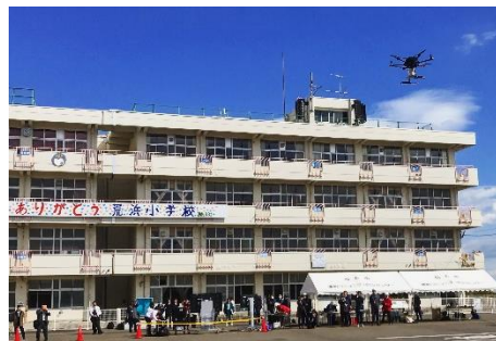
Jアラートによる自動発進、目視外の自動飛行
